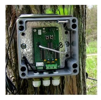
Das Gerät meldet den Ausfall der Hochspannung des Elektrozauns an bis zu 6 Telefonnummern, entweder als SMS oder als Telefonanruf. Um die Bereitschaft zu überprüfen in der Woche einmal eine SMS Bereitschaftsmeldung über verschickt. Diese übermittelt Spannung des Akkus, die Signalqualität der GSM-Verbindung und bei Benutzung von Prepaid-SIM-Karten Kontostand der SIM-Karte. den Umfassender kann Sicherheit nicht sein!
